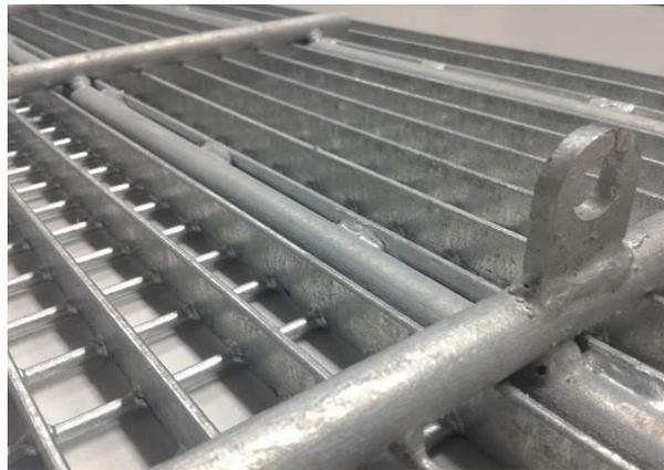
Geschweißte Kettenglieder werden unterhalb des Rostes angebracht. Diese Kette wird mittels übergestülpten Stahlrohr vor Durchtrennung geschützt. Unsere Spannvorrichtung verhindert das Aufhebeln des Gitters, dient aber gleichzeitig auch als Fluchtwegs - Entriegelung!
